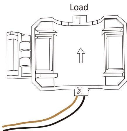
Figura 7.4 Seta Interna do Sensor de Corrente
