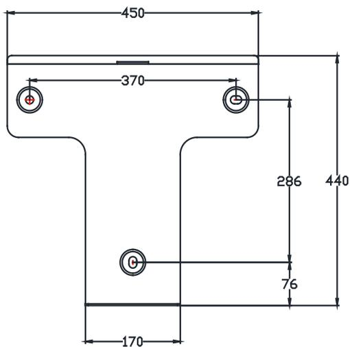
Figura 4.4 Suporte de Parede do Inversor
