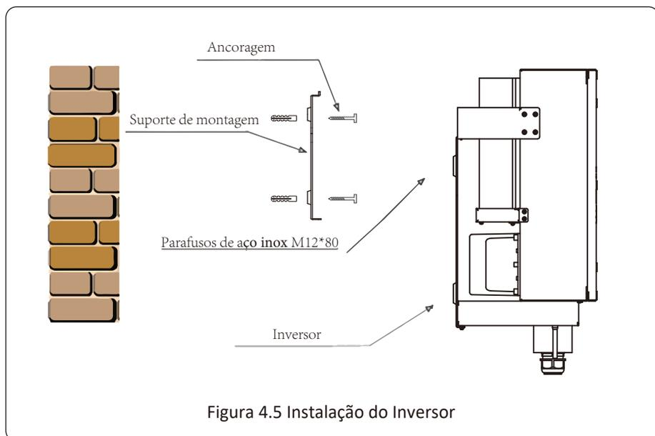
Figura 4.5 Instalação do Inversor
