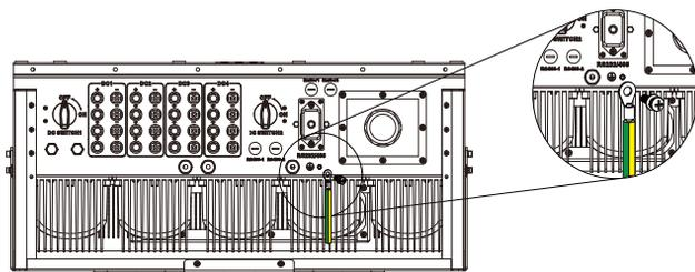
Figura 5.12 A instalação do Aterramento da Carcaça
