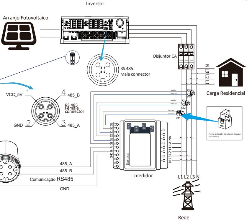
Figura 7.13 Diagrama da Comunicação do medidor Eastron
