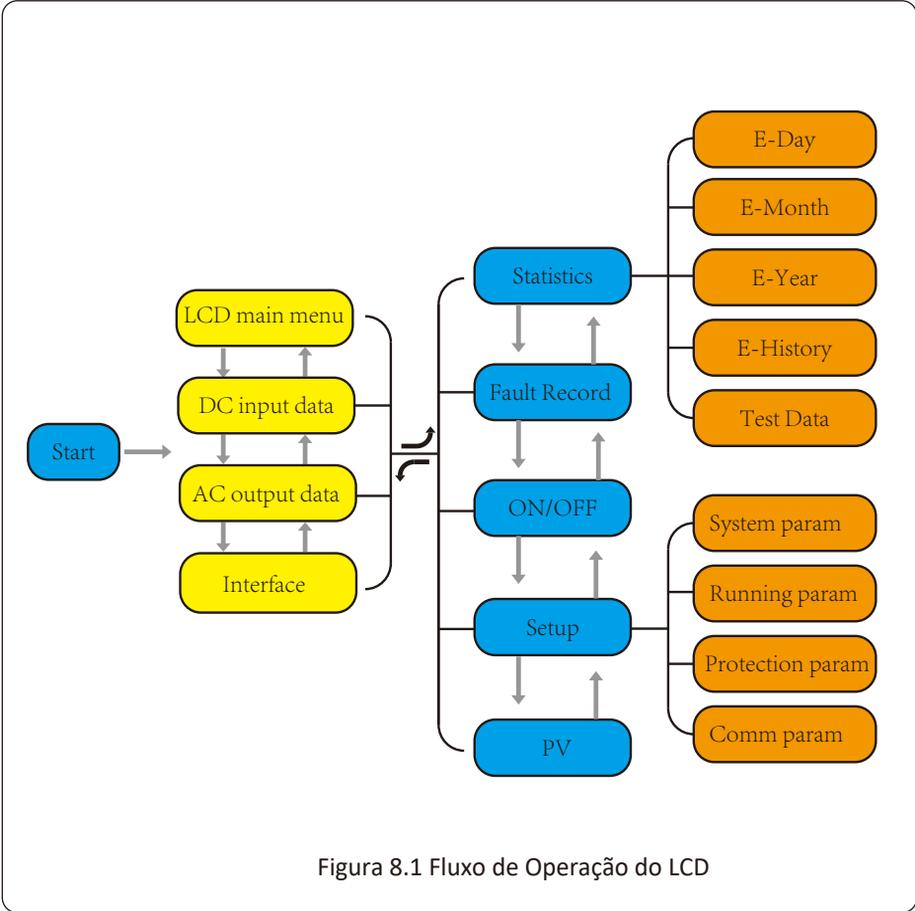
Figura 8.1 Fluxo de Operação do LCD
