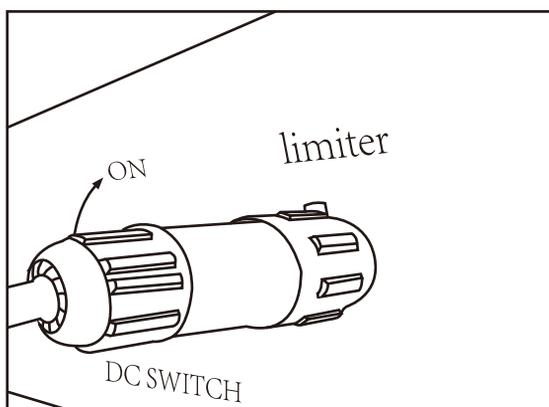
Figura 7.7 Conecte o terminal ao inversor
