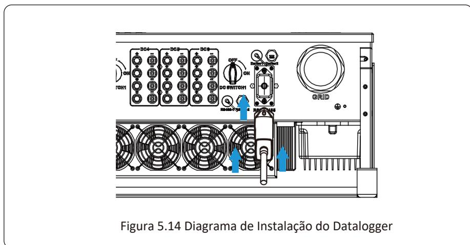
Figura 5.14 Diagrama de Instalação do Datalogger
