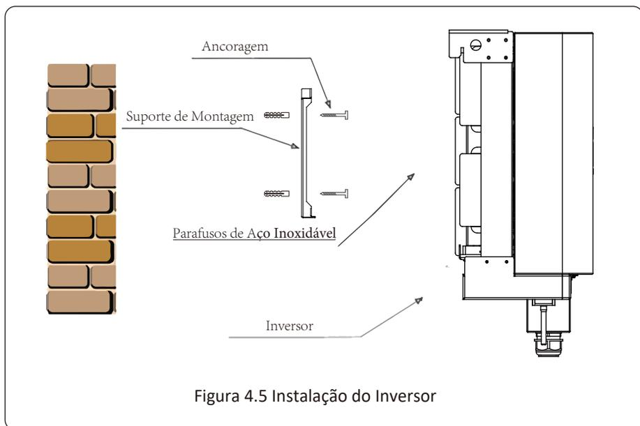
Figura 4.5 Instalação do Inversor
