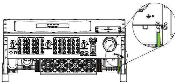
Figura 5.12 A instalação do Aterramento da Carcaça
