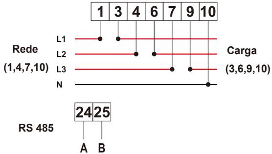
Figura 7.14 Medidor CHINT
