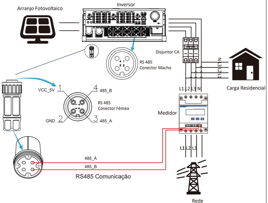
Figura 7.15 Conexão do diagrama do medidor CHINT
