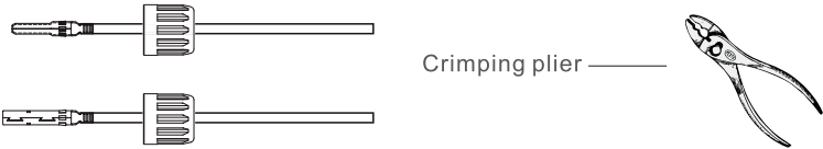
Figura 5.4 Crimpe o pino de contato no fio
